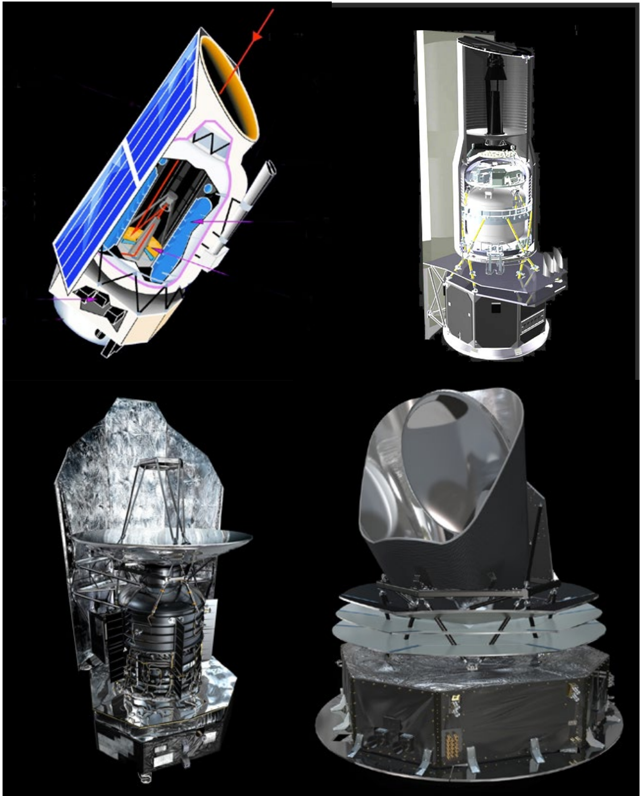
Fig.2. De gauche à droite et de haut en bas, des vues d'artiste des satellites ISO, Spitzer, Herschel et Planck, illustrant les différentes stratégies de refroidissement du télescope. Dans le cas d'ISO, le télescope est à l'intérieur du cryostat qui contient aussi les instruments situés derrière le miroir primaire. Dans le cas de Spitzer, il lui est connecté thermiquement et l'ensemble est isolé dans un système de tubes qui optimisent l'évacuation de la chaleur. Comme pour ISO les instruments sont eux dans le cryostat. Dans le cas d'Herschel, le télescope est aussi posé au-dessus du cryostat mais il ne lui est pas connecté. Le cryostat sert uniquement aux instruments. Le refroidissement du télescope de 3,5 m est uniquement passif du fait de l'ombre portée de l'écran solaire. Enfin pour Planck où le télescope doit être plus froid que celui d'Herschel, un système d'écrans enchâssés, dit en V-grooves, est positionné entre le télescope et le module de service et fait aussi écran aux rayons du Soleil situé « sous » le satellite dans cette représentation.
