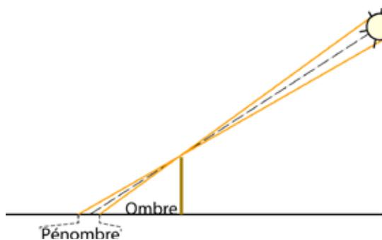
Si, comme Ératosthène, on mesure un angle de  $7,2^\circ$ , l'imprécision de  $0,5^\circ$  (pour deux mesures, dans chacune des villes) amène une erreur possible de 7 %, ce qui permet néanmoins d'avoir un bon ordre de grandeur.
