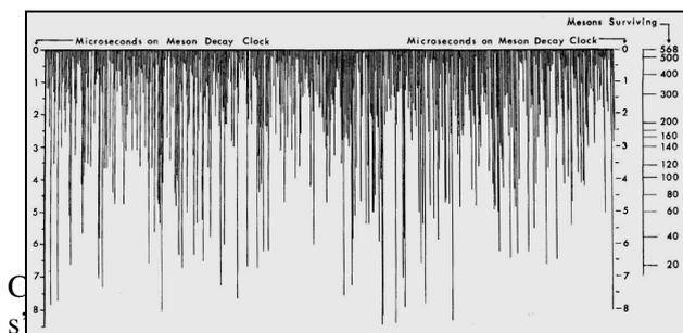
représente la durée de vie propre de la particule. Sur la droite est disposée une échelle donnant la correspondance entre le nombre de muons survivants et le temps écoulé depuis l'arrêt du muon. On constate que cette durée de vie varie dans de larges proportions. On peut rechercher la forme de la distribution en regroupant le nombre de survivants pour chaque tranche de 1  $\mu$ s.
