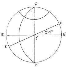
Le colure des solstices a pour projeté lui-même, les points  $\gamma$  et  $\gamma$  se projettent au centre du colure des solstices et le colure des équinoxes a pour projeté la droite (PP'). L'Equateur céleste se projette sur la droite (EE').
