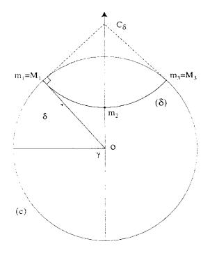
La projection stéréographique est conforme, i.e. "conserve" la mesure des angles. Le colure des solstices (C) fait un angle de 90° avec le parallèle ( $\Delta$ ) en  $M_1$  et  $M_2$  donc les projetés (c) et ( $\delta$ ) font aussi entre eux un angle de 90°, d'où  $OC_{\delta} = R$  / sin d
