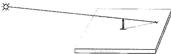
On note à différentes heures de la journée la position de l'ombre d'un point. On peut réaliser ce genre de relevé directement au sol avec un bâton vertical ou sur une planchette de bois. Dans ce cas, on observera l'ombre de l'extrémité d'un clou, d'une vis, ou d'un rivet fixé sur la planche.
