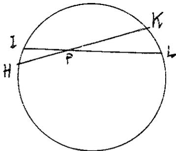
Newton dessine une figure plane, un cercle et le point P à l'intérieur ; il trace deux droites IPL et HPK qui délimitent deux arcs HI et KL supposés infiniment petits et qui seront proportionnels à PH et PL. Les petites parties de la sphère découpées par des lignes telles que HK et IL seraient comme les carrés de PH et PL. D'où il suit que les attractions de ces petites parties de sphère sur P sont exactement opposées et s'annulent.
